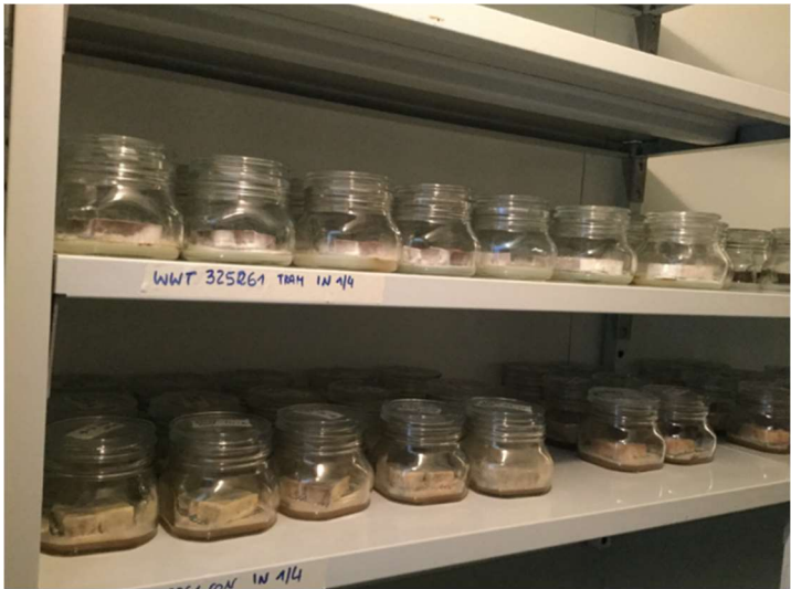
Figura: Prova di durabilità secondo normativa EN 113-2:2020, CATAS, Udine
