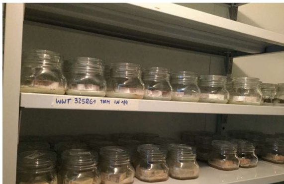
Figura: Prova di durabilità secondo normativa EN 113-2:2020, CATAS, Udine
